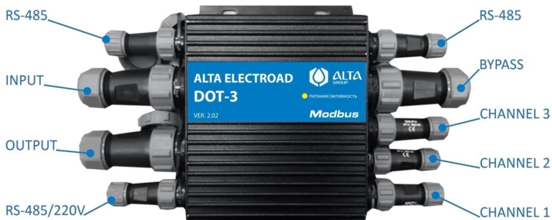
Рисунок 23. Внешний вид с указанием назначения разъемов и индикации прибора ALTA ELECTROAD DOT
