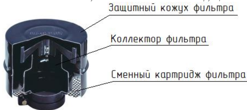
Рисунок 37. Внешний вид и конструкция воздушного фильтра.
