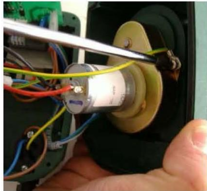
Рисунок 55. Порядок действий при замене прижимных роликов в насосе-дозаторе Etatron B3-V PER 1–3 90/260V SANT
